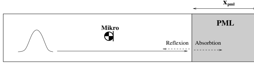
Abbildung 4.2: Rechengebiet zur Untersuchung der PML-Randbedingung mit eingezeichneter Position des „Mikros“
